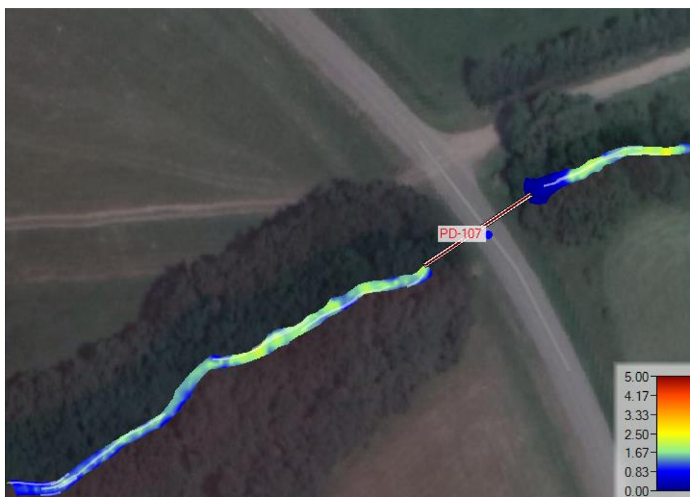
Rysunek 48 Rozkład prędkości wody – zakres analizy dla obiektu PD-107
