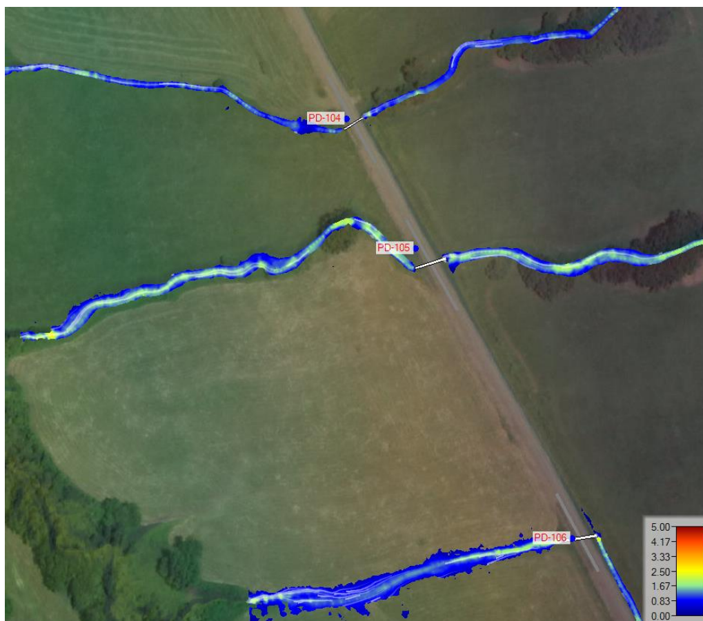
Rysunek 47 Rozkład prędkości wody – zakres analizy dla obiektów PD-104, PD-105, PD-106
