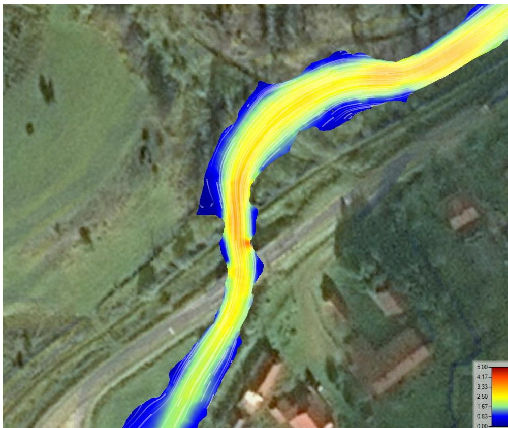
Rysunek 38. Rozkład prędkości w rejonie mostu M9 na Solince – Q_{maxp0.5\%} .
