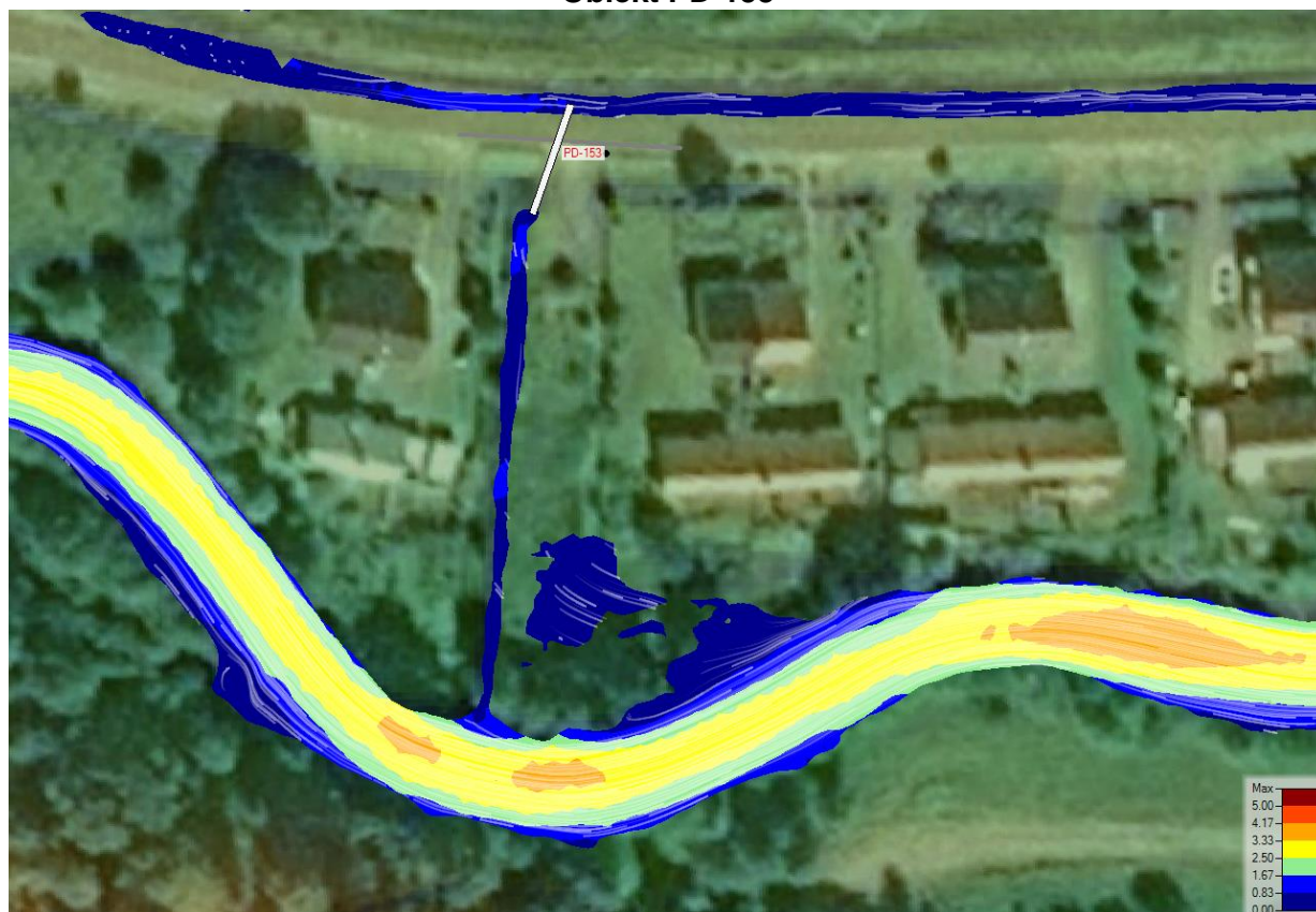
Rysunek 186. Rozkład prędkości wody Q_{maxp0.5\%} dla obiektu PD-153.
