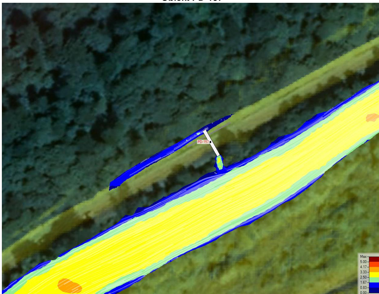
Rysunek 198. Rozkład prędkości wody Q_{maxp0.5\%} dla obiektu PD-157.
