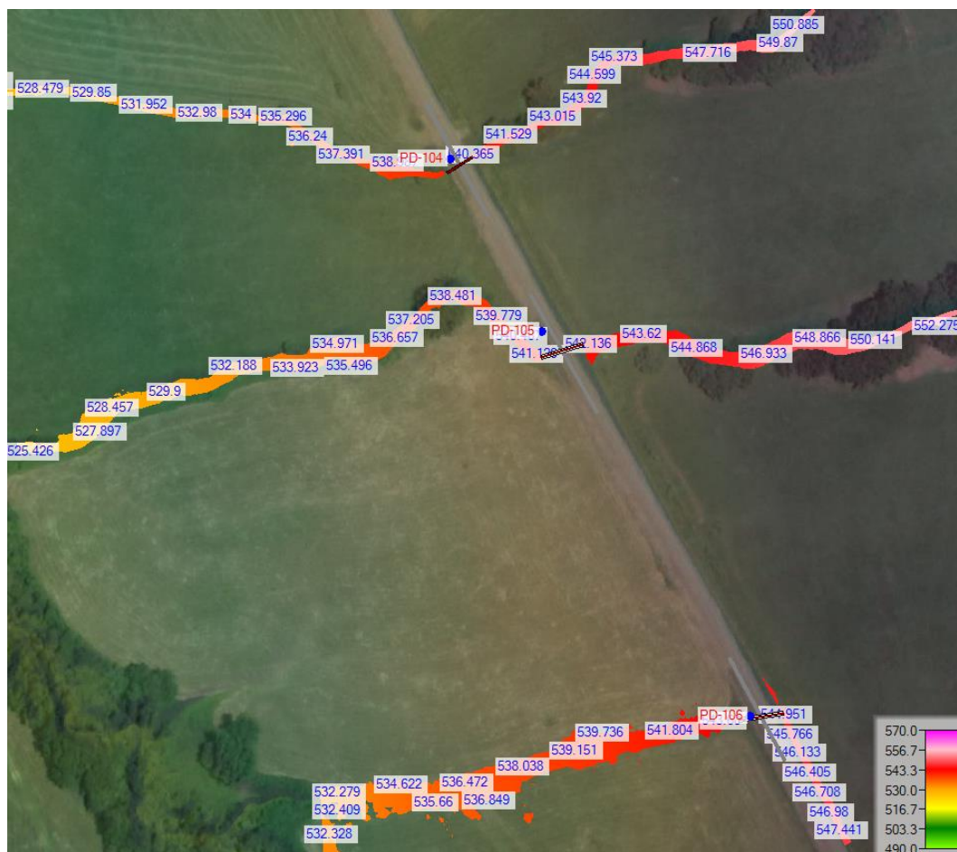
Rysunek 50 Rozkład poziomów wody – zakres analizy dla obiektów PD-104, PD-105, PD-106
