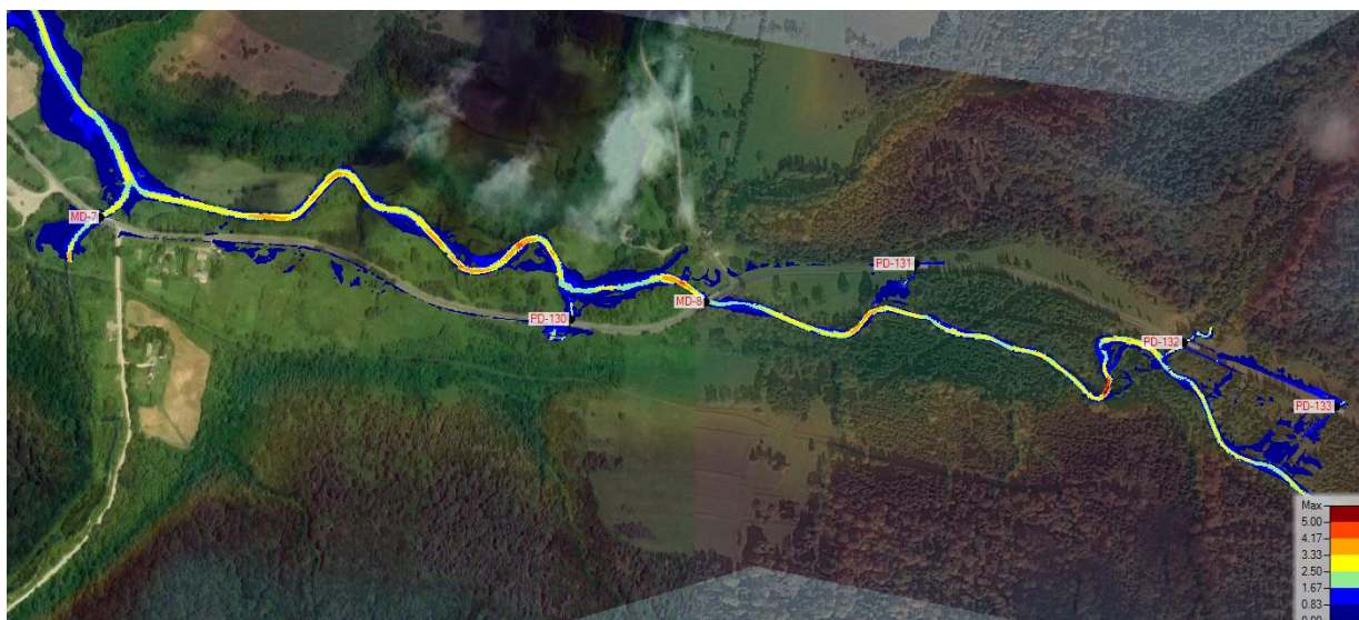
Rysunek 124. Rozkład prędkości wody Q_{maxp0.5\%} – zakres analizy dla obiektów MD-7, PD-130, MD-8, PD-131, PD-132, PD-133.
