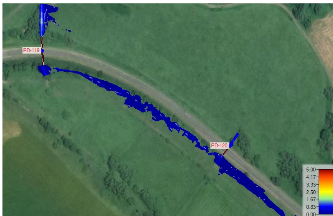
Rysunek 96 Rozkład prędkości wody – zakres analizy dla obiektów PD-119, PD-120
