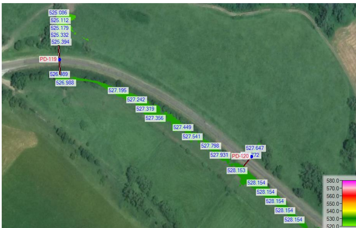
Rysunek 99 Rozkład poziomów wody – zakres analizy dla obiektów PD-119, PD-120
