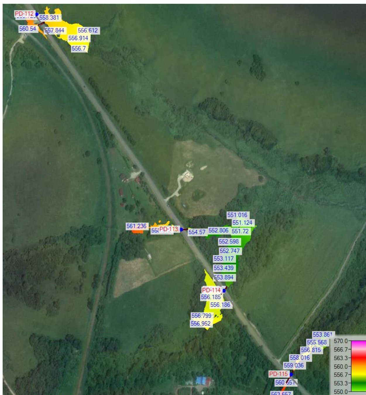
Rysunek 79 Rozkład poziomów wody – zakres analizy dla obiektów PD-112, PD-113, PD-114, PD-115
