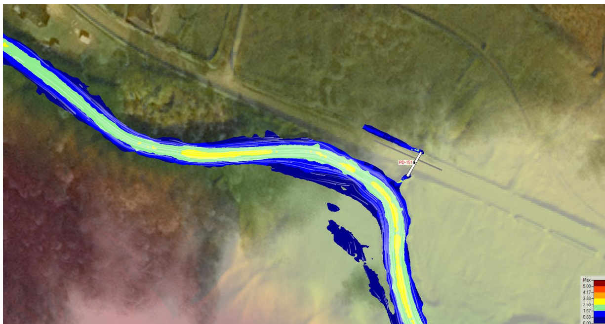
Rysunek 182. Rozkład prędkości wody Q_{maxp0.5\%} dla obiektu PD-151.
