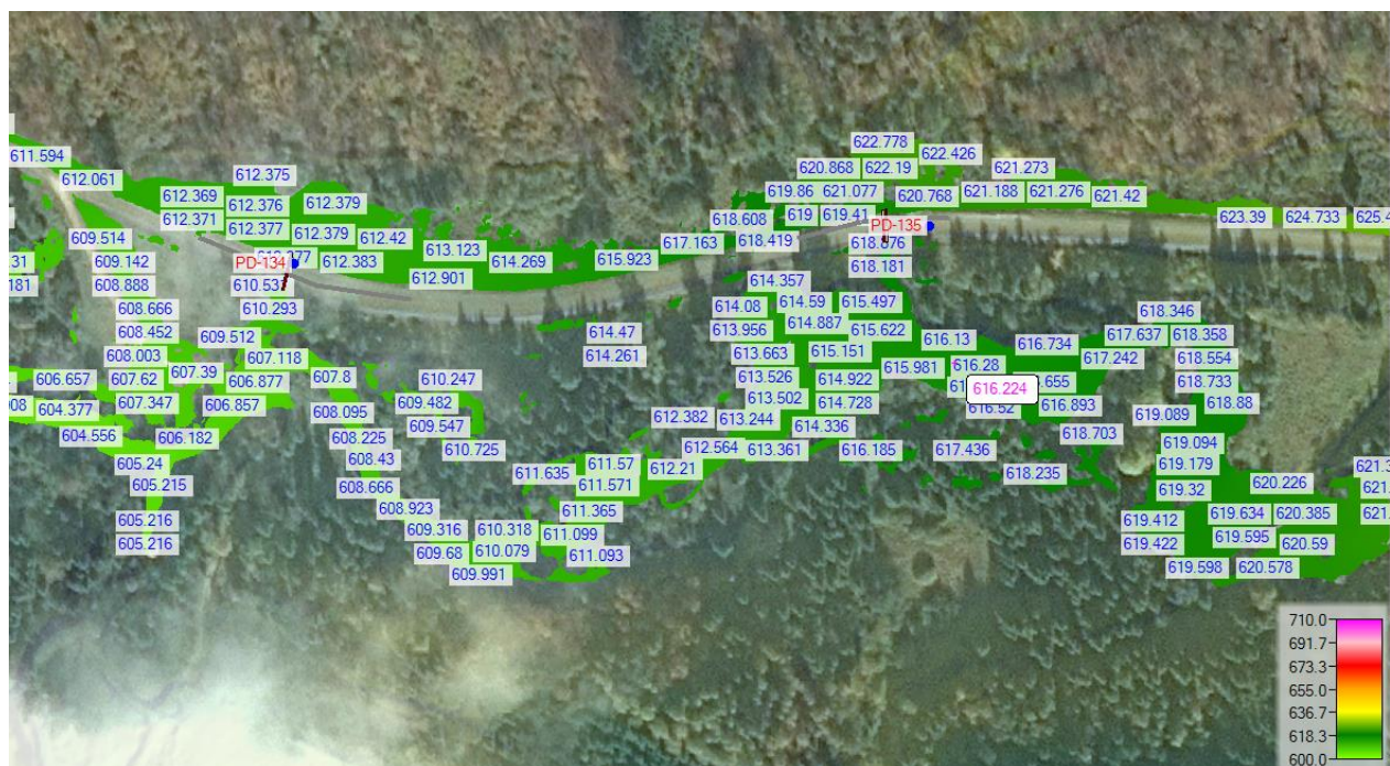
Rysunek 137 Rozkład poziomów wody – zakres analizy dla obiektów PD-134, PD-135
