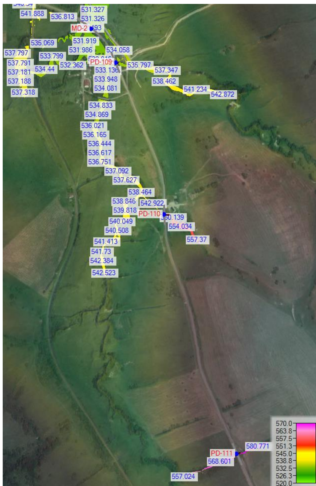
Rysunek 67 Rozkład poziomów wody – zakres analizy dla obiektów MD-2, PD-109, PD-110, PD-111
