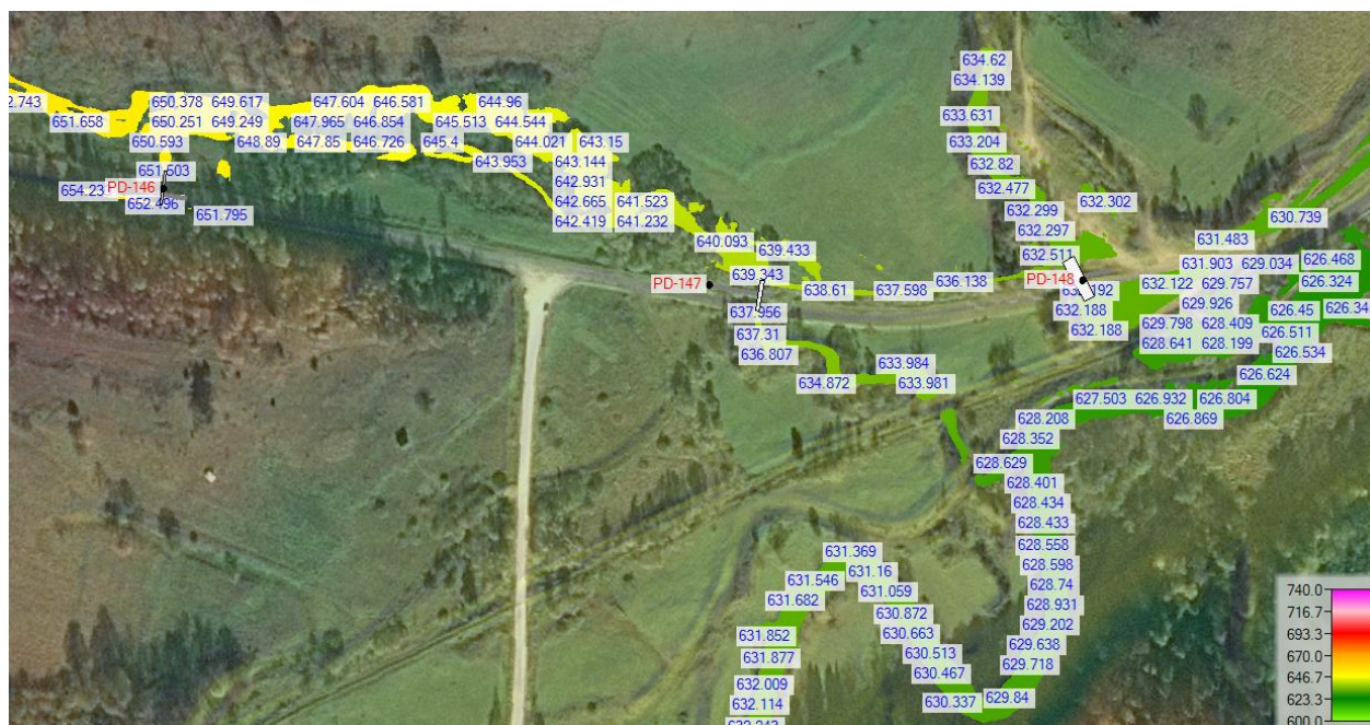
Rysunek 158 Rozkład poziomów wody – zakres analizy dla obiektów PD-146, PD-147, PD-148
