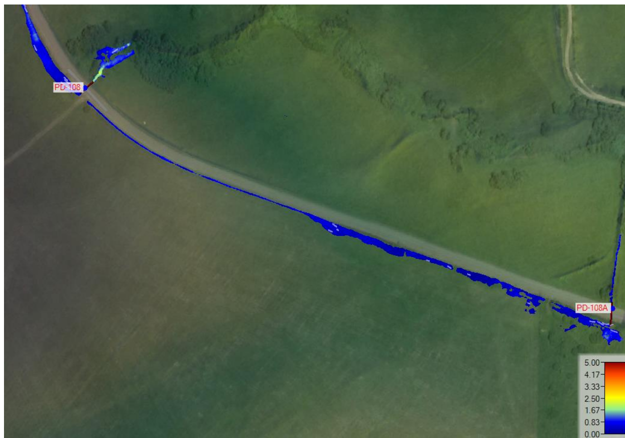
Rysunek 64 Rozkład prędkości wody – zakres analizy dla obiektów PD-108, PD-108A
