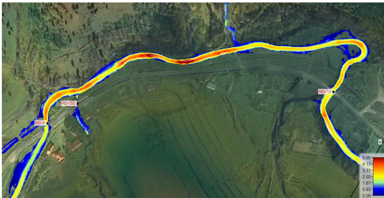
Rysunek 156 Rozkład prędkości wody – zakres analizy dla obiektów MD-9, PD-150, MD-10
