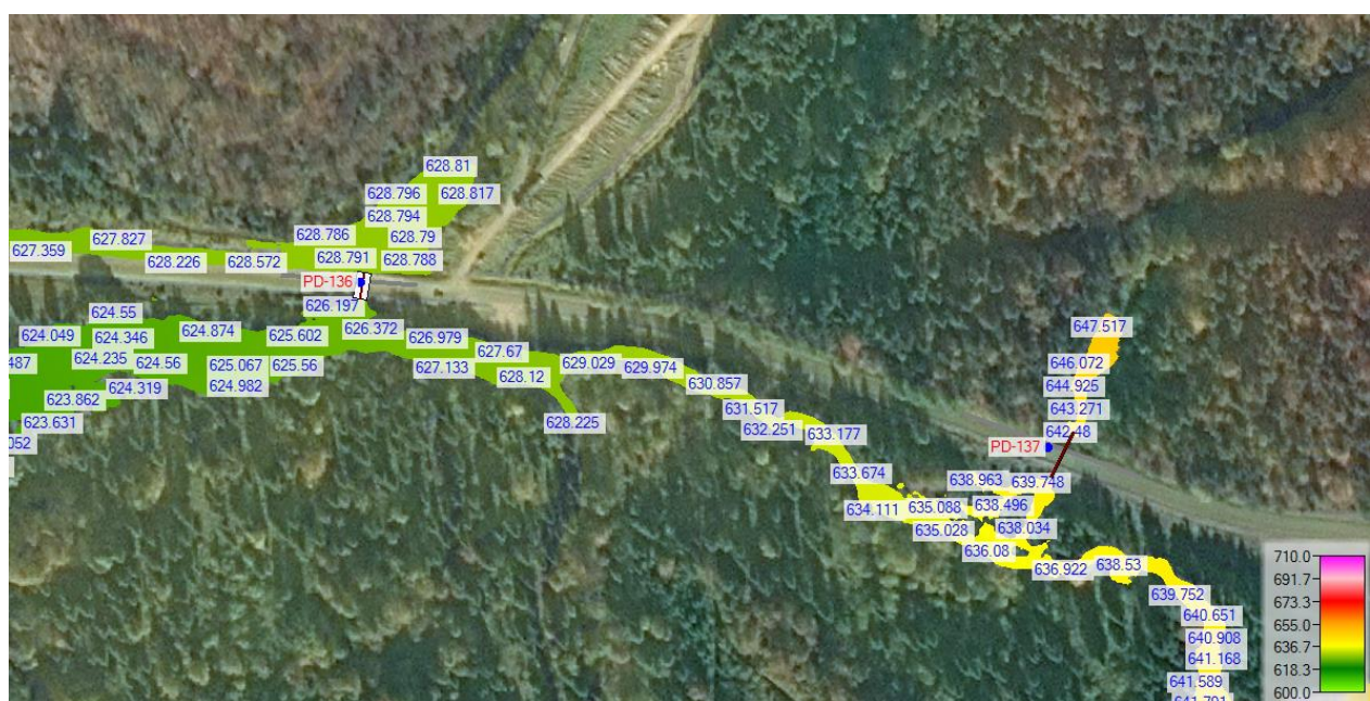
Rysunek 138 Rozkład poziomów wody – zakres analizy dla obiektów PD-136, PD-137
