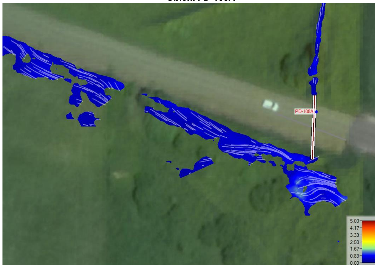
Rysunek 70 Rozkład prędkości wody dla obiektu PD-108A
