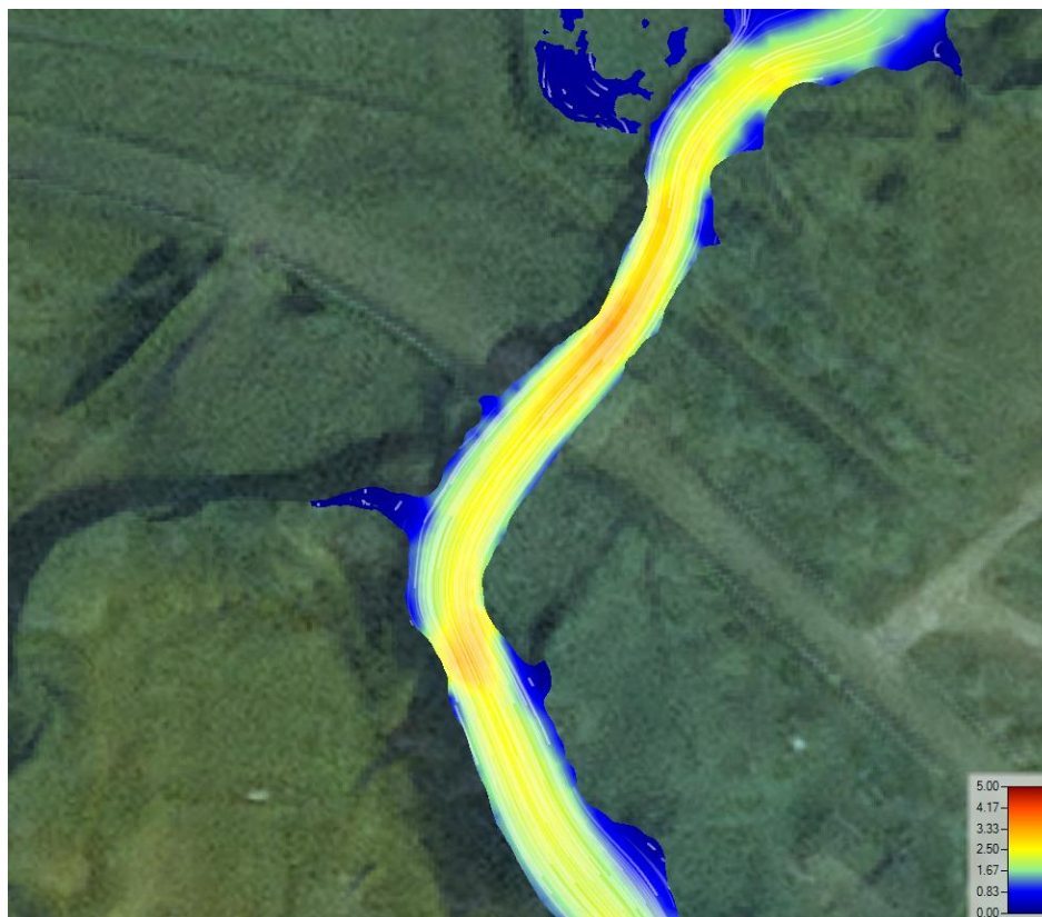
Rysunek 40. Rozkład prędkości w rejonie mostu M10 na Solince – Q_{maxp0.5\%} .
