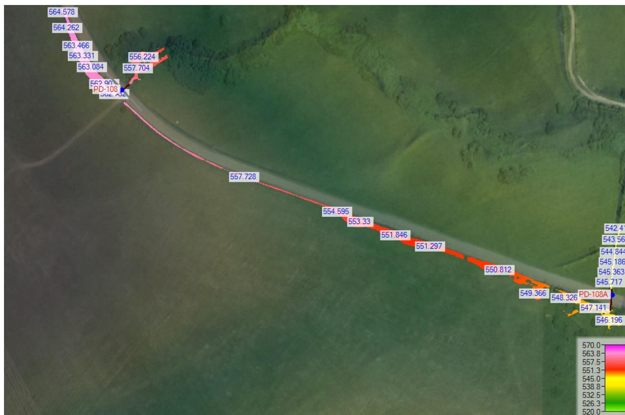
Rysunek 66 Rozkład poziomów wody – zakres analizy dla obiektów PD-108, PD-108A
