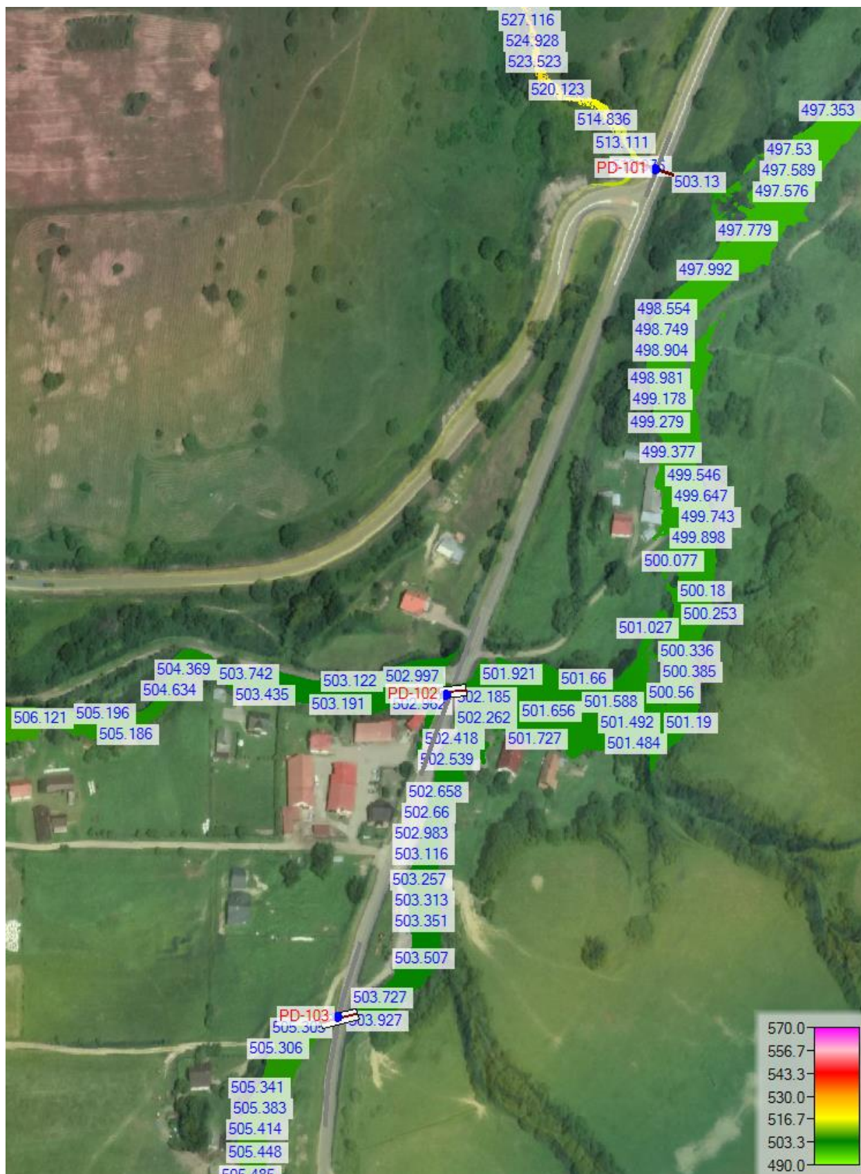
Rysunek 49 Rozkład poziomów wody – zakres analizy dla obiektów PD-101, PD-102, PD-103
