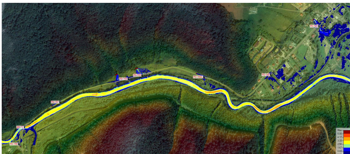
Rysunek 179. Rozkład prędkości wody Q_{maxp0.5\%} – zakres analizy dla obiektów PD-156, MD-12, PD-157, PD-158, PD-159, PD-159A, PD-160, PD-161.
