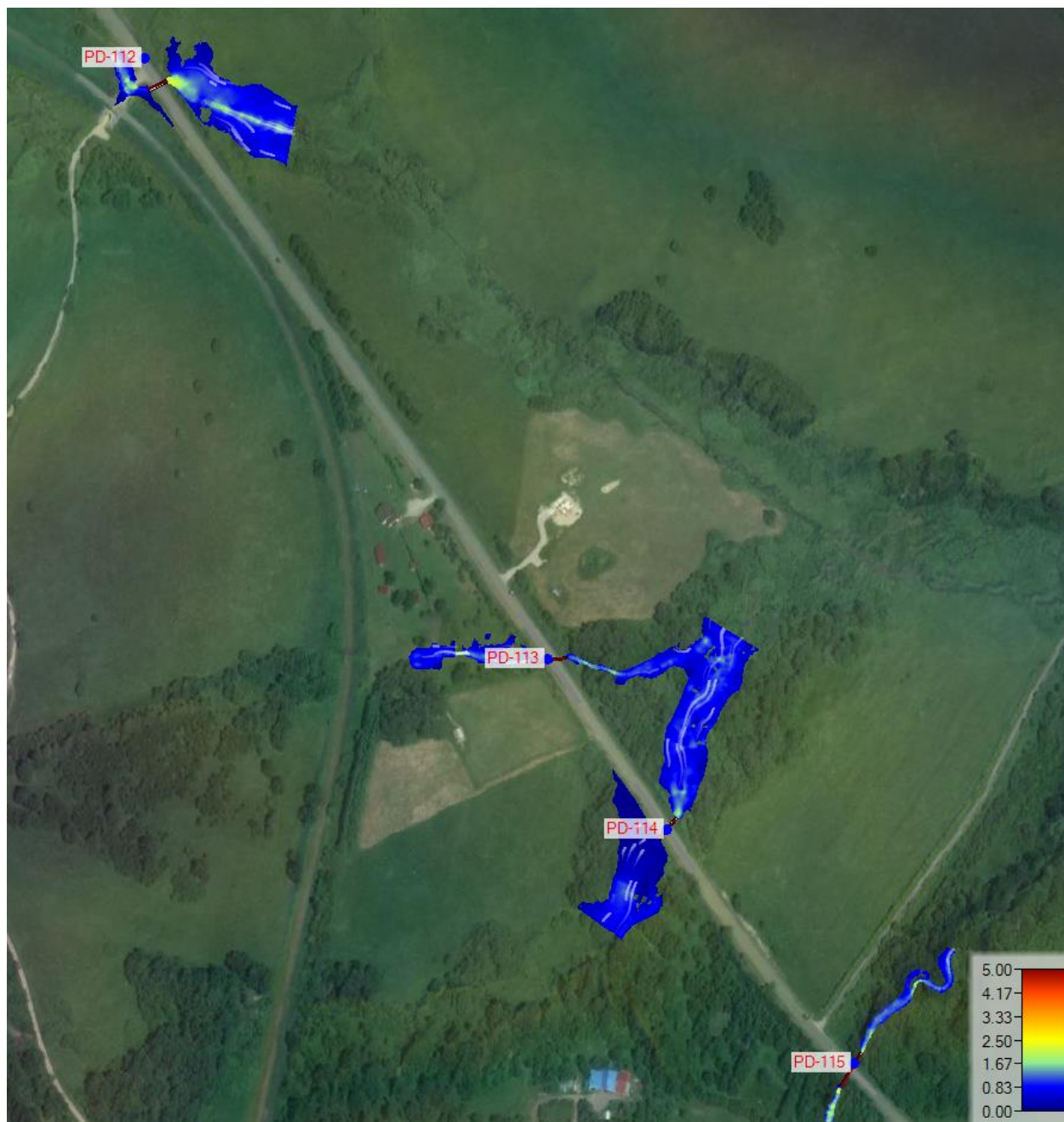
Rysunek 78 Rozkład prędkości wody – zakres analizy dla obiektów PD-112, PD-113, PD-114, PD-115
